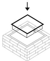
Insérer les 2 pièces de la cuve intérieure.
