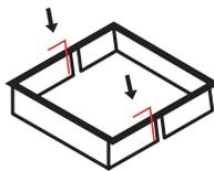
Insérer les 2 tiges pour joindre les 2 pièces de la cuve intérieure ensemble.
